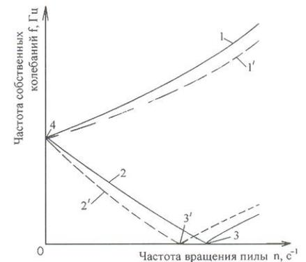
**Графики зависимости частоты собственных колебаний диска от частоты вращения пилы:**
