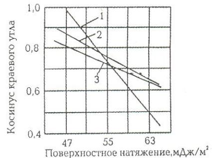
Рис. 1. Графики зависимости краевого угла смачивания от поверхностного натяжения при разной степени обработки поверхности подложки из древесины красного дерева:
