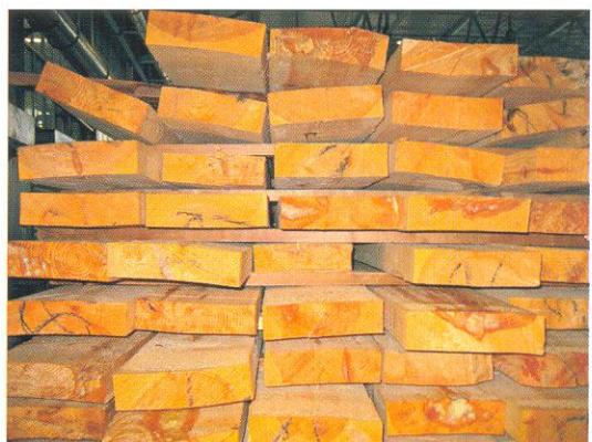
Рис. 4. Недопустимые дефекты формы заготовок
