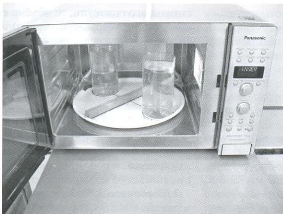
Рис. 1. Размещение образца массивной древесины дуба и стаканов с водой в объёмном резонаторе СВЧ-печи
