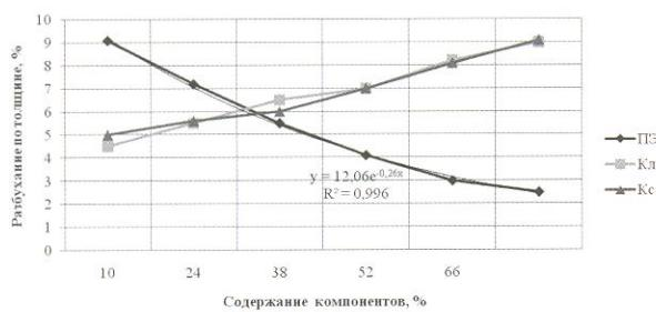
**Рис. 2. Графики зависимости коэффициента разбухания плит из древесной коры и вторичного ПЭНД по толщине от о.м.с. в плитах компонентов**
