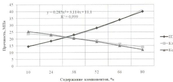
**Рис. 1. Графики зависимости предела прочности плит из древесной коры и вторичного полиэтилена низкого давления (ПЭНД) при изгибе от относительного массового содержания (о.м.с.) в плите компонентов**
