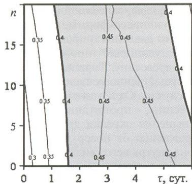
**Рис. 5. Оптимальная область факторного пространства ( $\tau$ ,  $n$ ) для предела прочности плит при растяжении перпендикулярно пласти**
