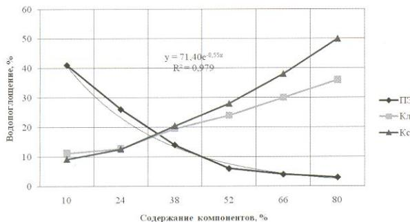
**Рис. 3. Графики зависимости коэффициента водопоглощения плит из древесной коры и вторичного ПЭНД от о.м.с. в плитах компонентов**
