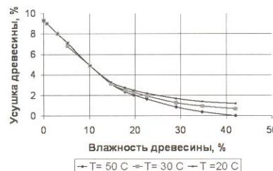
Рис. 3. Графики зависимости тангенциальной усушки древесины сосны от её влажности – при различных значениях температуры воздуха
