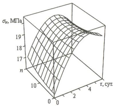
**Рис. 4. Двумерное графическое представление зависимости предела прочности плиты при изгибе от месторасположения плиты в стопе и продолжительности её выдержки в стопе**
