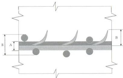
**Рис. 3. Модель области проникновения клея в древесину на участках впадин пресс-формы**
