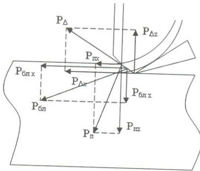
Рис. 2. Схема сил, действующих на заготовку со стороны резца и прижимной линейки
