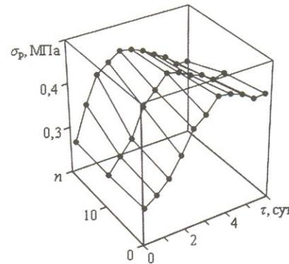
Рис. 1. Оптимизационная поверхность отклика в отношении предела прочности плит при растяжении перпендикулярно пласти
