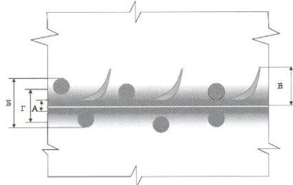
**Рис. 4. Модель области проникновения клея в древесину на участках выступов пресс-формы**
