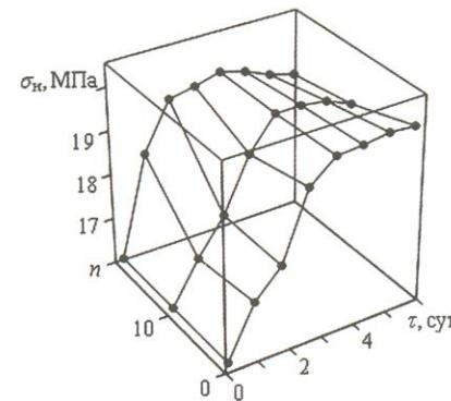
Рис. 2. Оптимизационная поверхность отклика в отношении предела прочности плит при изгибе
