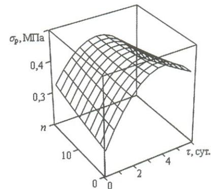
Рис. 3. Двумерное графическое представление зависимости предела прочности плит при растяжении перпендикулярно пласти от месторасположения плиты в стопе и продолжительности её выдержки в стопе
