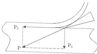
Рис. 1. Схема сил, действующих на заготовку со стороны резца
