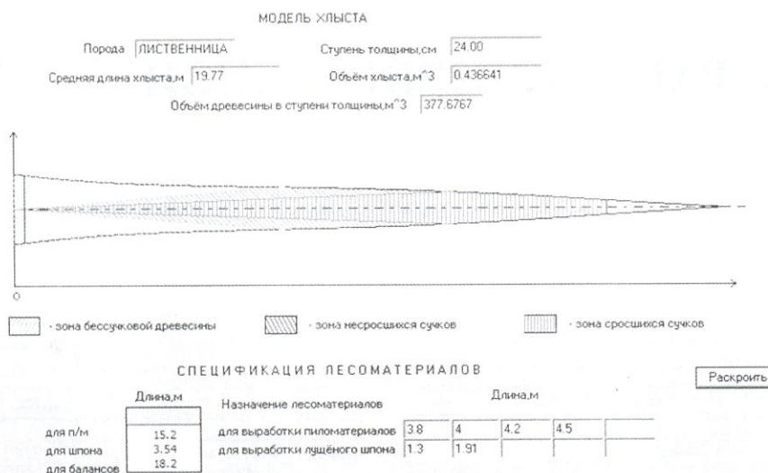
Рис.3. Диалоговое окно для визуализации двумерной модели хлыста
