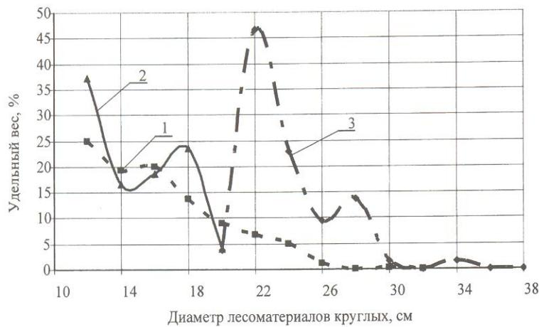
Рис. 5. Графики распределения круглых лесоматериалов по величинам диаметра – для разных схем раскроя хлыстов:
