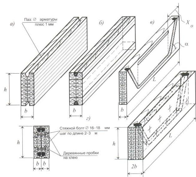
Рис. 3. Варианты схемы технологического процесса изготовления деревянных армированных балок:
