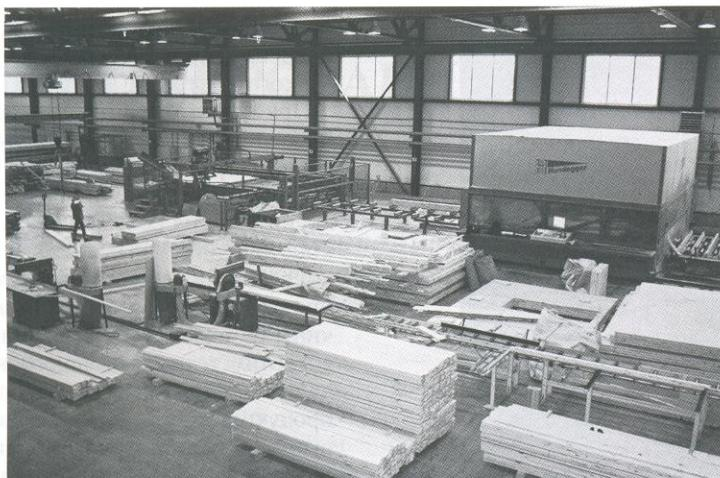
**Рис. 2. Участок производства массивных панелей МНМ**
