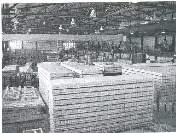
Рис. 1. Участок производства каркасных панелей
