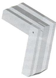
Рис. 1. Твердотельная модель углового соединения створки оконного блока
