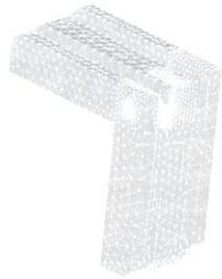
Рис. 2. Результат генерирования объёмной конечно-элементной сетки углового соединения
