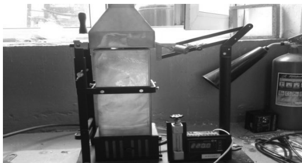
Рис. 3. Внешний вид установки, предназначенной для определения горючести веществ.
