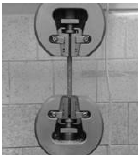
Рис. 4. Механические испытания образцов композита при определении предела прочности на разрыв
